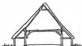
doorsnede driebeukige hallehuisboerderij. (verbreide middenbeuk.) vanaf 13 eeuw.
